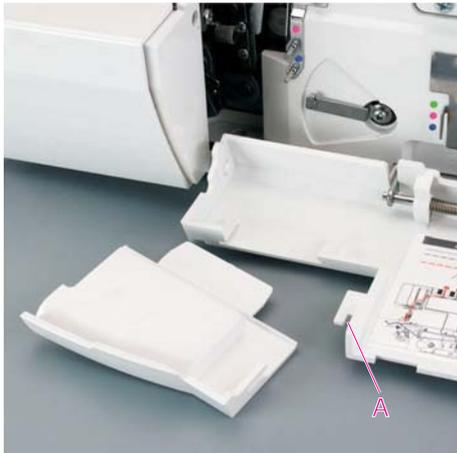
Per fissare la placca copertura overlock fare scivolare la base verso lo sportello frontale e inserirlo nella posizione corretta fino ad innestare l'apposita linguetta nel fermo (A) del coperchio crochet.
